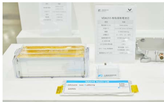
工研院開發以NAEPE為材料的「高能量高安全樹脂固態電池」，取代目前易燃的電解液，不僅大幅提升電池的安全性，也增高電池新的能量密度，獲得全球百大科技研發獎的殊榮。
