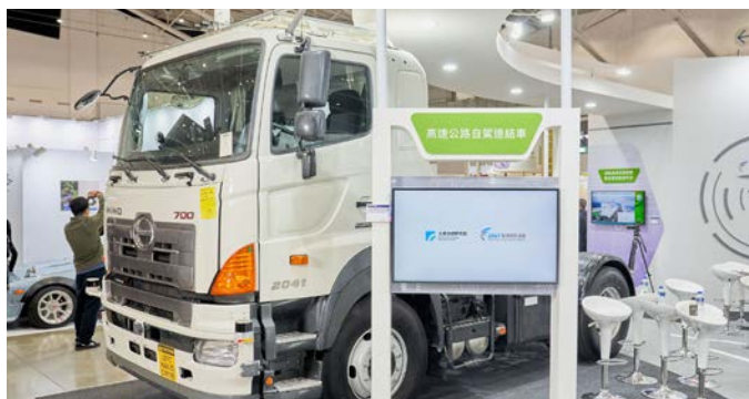
工研院將自主研发的高速公路自駕技術導入35噸聯結車，並與澳洲最大公路營運企業Transurban合作，讓聯結車在時速80公里的情境下高速奔馳時，仍能精準控制與定位。
