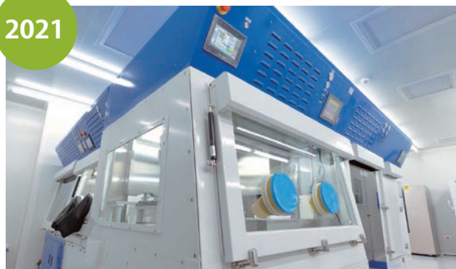
工研院開發出的臺灣第一座MIT貼附型細胞自動化生產系統，結合機械手臂，可客製化搭配不同模組打造出專屬設備。
