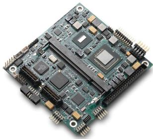
凌華科技發表「Ampro by ADLINK™」產品系列的開創性設計的新產品「CoreModule® 730」，這是全球第一款基於SUMIT™介面的產品，為小尺寸寬溫級單板電腦產品帶來結構上的嶄新進展，展現凌華科技在工業級與軍事用電腦產品的優異研發能力。凌華科技 CoreModule® 730 軍用寬溫級小型電腦，搭載超低功耗 1.1GHz 的英特爾 Atom™ Z510 或 1.6GHz 的 Atom™ Z530 處理器，以及容量達 2 GB 的 DDR2 533MHz SODIMM 記憶體插槽，使用最新的 SUMIT™擴充介面。CoreModule® 730 重新改良堆疊與夾層架構，將龐大的資料頻寬與完整的連接性整合到板上，配置於板上的零碎空間，這些連接介面包括 PCI Express™通道、USB 2.0 介面、LPC 匯流排、I2C 匯流排與 SPI 匯流排等。過去，這些支援介面的空間都被 33 MHz 的並列
