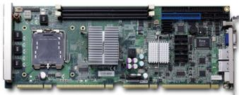
凌華科技推出符合 PICMG<sup>®</sup> 1.3 SHB(System Host Board)規格之工業用插槽式單板電腦「NuPRO-E320」，適用 45 奈米製程技術之英特爾 Core<sup>™</sup>2 Quad 四核心或 Core<sup>™</sup>2 Duo 雙核心處理器，處理器速度可達 3.00 GHz。凌華 NuPRO-E320 支援 800/1066
