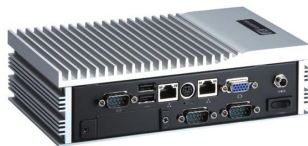
艾訊高規節能 Intel® Atom™ N270 無風扇強固型嵌入式迷你電腦系統 eBOX620-831-FL
