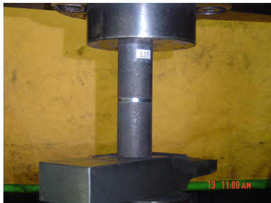
圖五 兩複合發泡鋁鋼管以萬能試驗機進行抗壓縮強度測試
