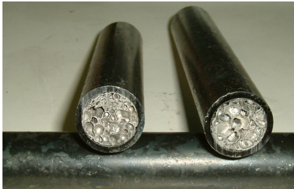
圖二 製作完成之內覆發泡鋁複合鋼管發泡密度為 0.69g/cm 3
