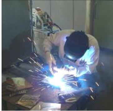
圖四 電弧銲接進行情形
