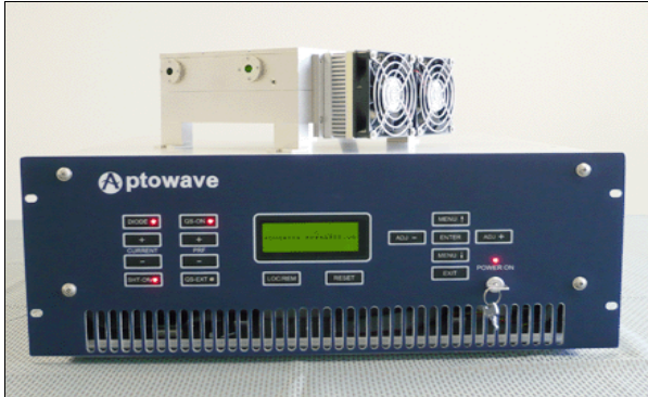
圖一 DPSS 紫外光雷射器[2]
