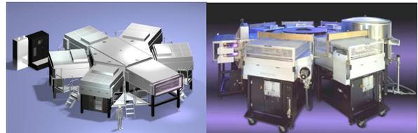
圖二 (a)群集式(Cluster)多腔體製程設備；(b)商業機台
