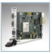
NI 發表 NI PXIe-1435 高效能 Camera Link 影像 擷取卡。新款模組可於 PXI 系統中整合高速、 高解析度的成像功能;而其所適用的自動 化測試作業,亦已超過 70 家製造商提供 1,500 款以上的量測模組。高 傳輸率的成像功能,搭 配現成的 PXI 量測硬體 優勢,NI 完整的軟體定義 解決方案,更適用於高系 統需求的自動化測試應用(如 汽車、半導體、消費性電子)。
