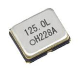
精工愛普生公司(簡稱「Epson」)近日宣佈開發出三種全新系列的精巧型石英振盪器產品。新的 SG-210S\*H系列振盪器尺寸為 2.5 mm × 2.0 mm,能在 80 MHz 至 170 MHz 的範圍內以穩定的高頻基本波振盪,本系列產品將從2012年4月開始量產。
