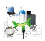
與傳統的 PC-based 板卡相比,需花費許多時間在安裝板卡,且因 PC 體積龐大不易移動。USB-2019 為泓格新推出USB 介面資料擷取的解決方案,可以使用標準 USB 連接各式類比信號設備,由於 USB具備隨插即用功能,因此能夠快速地透過本模組擷取資料至電腦上。
