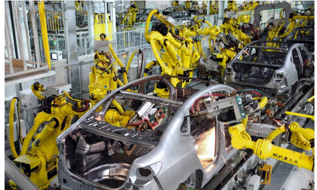
圖 1 應用於汽車車體焊接工作之機器人[2]
