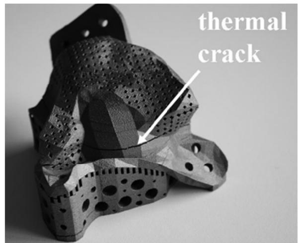
圖1 積層製造因製作過程產生熱應力所造成之破壞[1]
