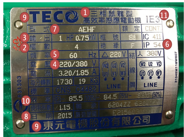
圖 1 三相鼠籠型高效率感應電動機銘牌示意圖
