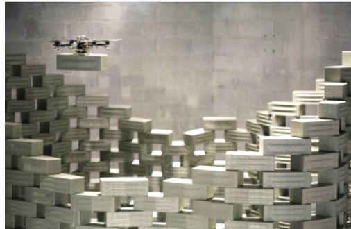
瑞士 ETH Zurich 大學開發的小型無人飛行器及堆疊磚牆實況[1]
