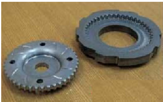
圖 3 日本 Syvec Corporation 利用板鍛成形製程之擺線齒輪
