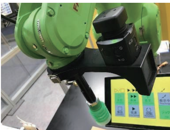
圖 4 FANUC 小型協同作業機器人用之手持引導器
