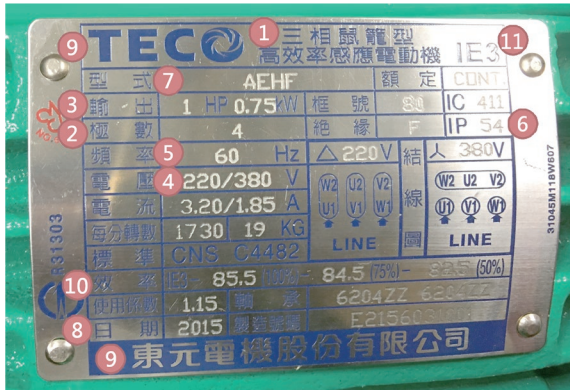
圖 1 三相鼠籠型高效率感應電動機銘牌示意圖
