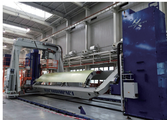
圖 3 Electroimpact 公司龍門式鑽孔系統 E7000 Fuselage Riveting Machine[8]
