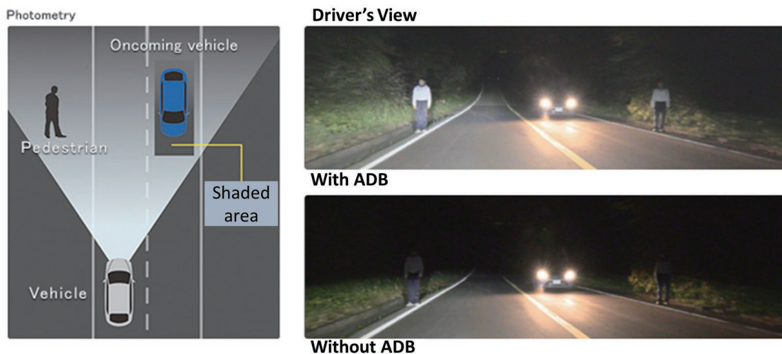
圖 2 自適性車頭燈系統適用情境 [2]
