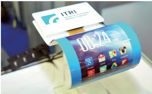
「腕戴式互動顯示裝置」具備可彎曲、輕量化與耐衝擊特性，非常適合曲面穿戴的應用。
