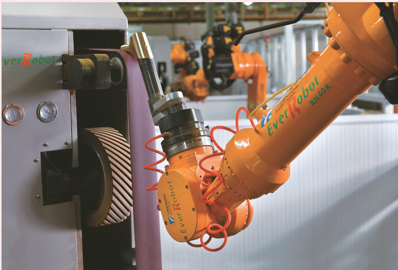
工研院成功開發出 CPS 研磨拋光機器人技術，希望用機器人來做拋光的動作，解決國內水五金產業在研磨拋光製程上遇到的人力缺工問題。
