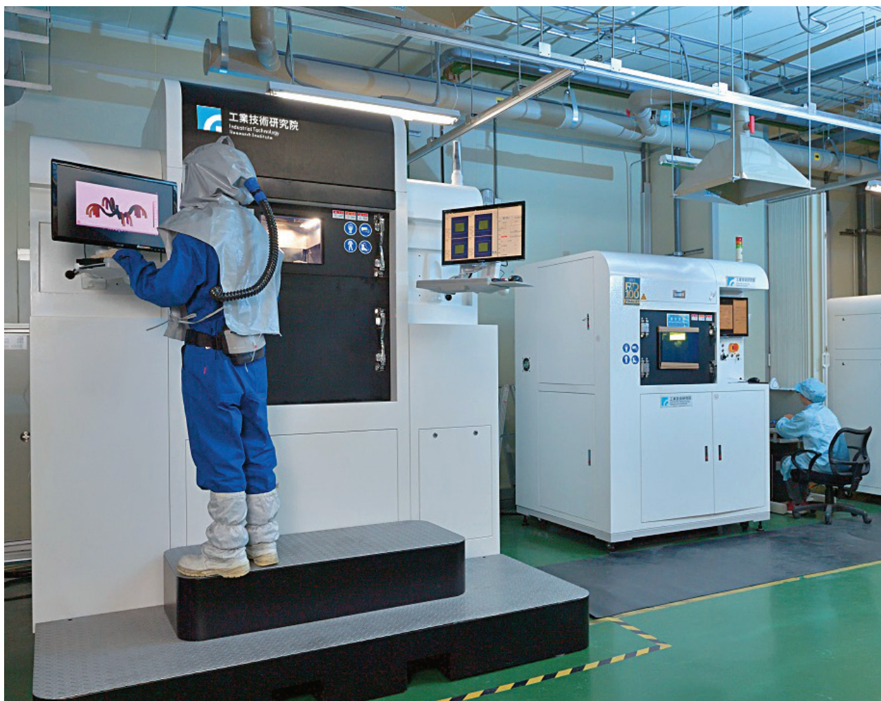
工研院的大尺寸金屬 3D 列印設備可四區同步熔融，產能最高可提升四倍。
