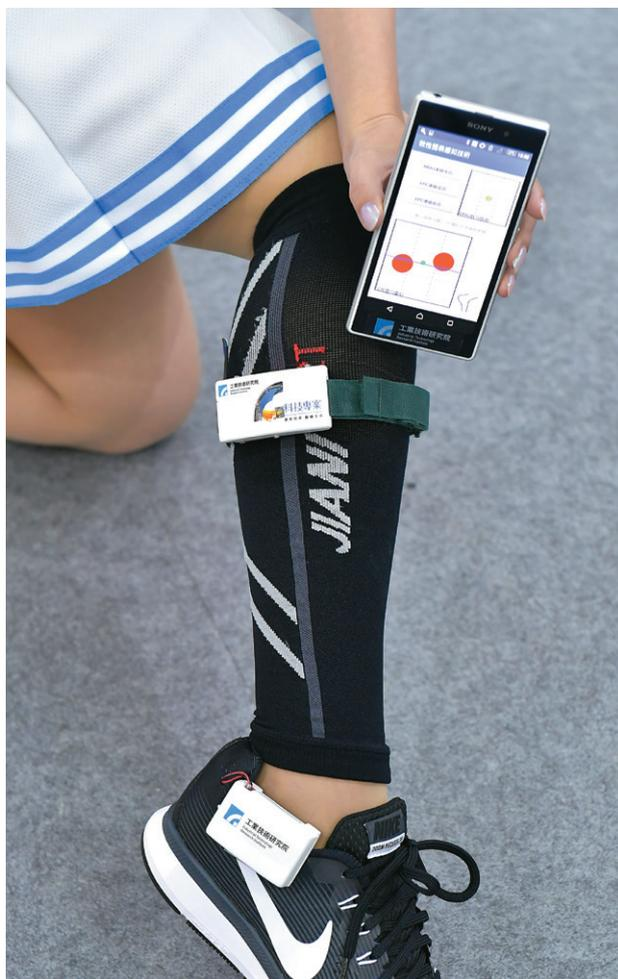
工研院研發的 MMG 裝置可偵測肌肉活動變化、傾斜程度與足底壓力數據，一旦偵測到風險，即會發出警訊並通知照護人員或機構，時時照顧你的安全。
