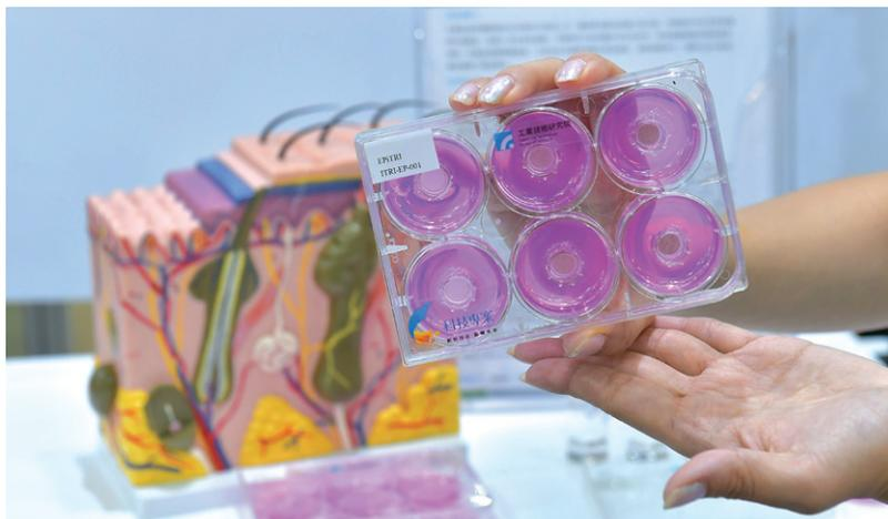
工研院首創高品質人工表皮組織 EPITRI，具正確的表皮組織多層分化型態，已通過跨國多實驗室的皮膚刺激性與腐蝕性測試驗證，將成為化妝品測試的新星。
