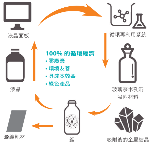
廢液晶面板再利用處理系統圖解
