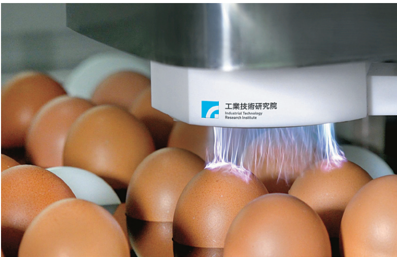
工研院研發的大氣電漿技術，應用於雞蛋殺菌流程，可保護消費者不受病菌侵襲。
