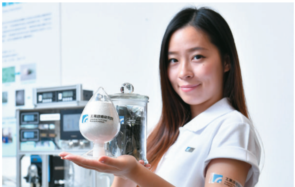
「奈米孔洞玻璃吸附材料」，可應用於重金屬廢水的處理，處理後的廢水可再利用，重金屬脫附濃縮，可精鍊為金屬原料。
