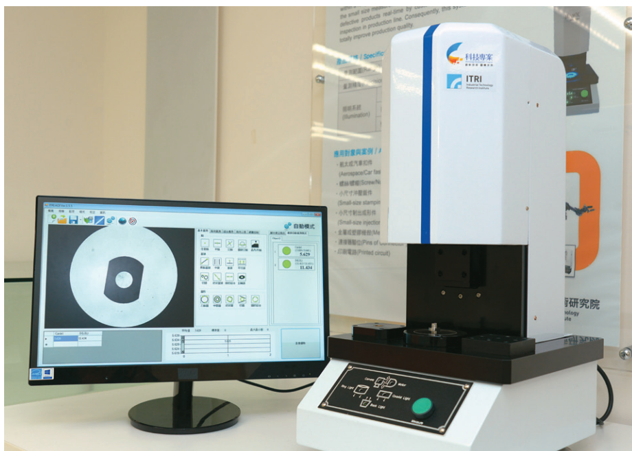
工研院研發的 AOI 精密自動光學量測系統，可立即記錄量測資料，傳至後端的資料庫，運用機器學習等 AI 技術進行分析。
