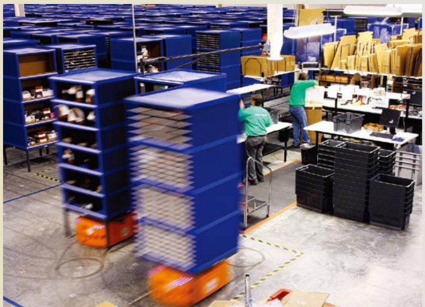
Kiva公司製造的機器人在倉庫現場移動堆放產品的層架。
