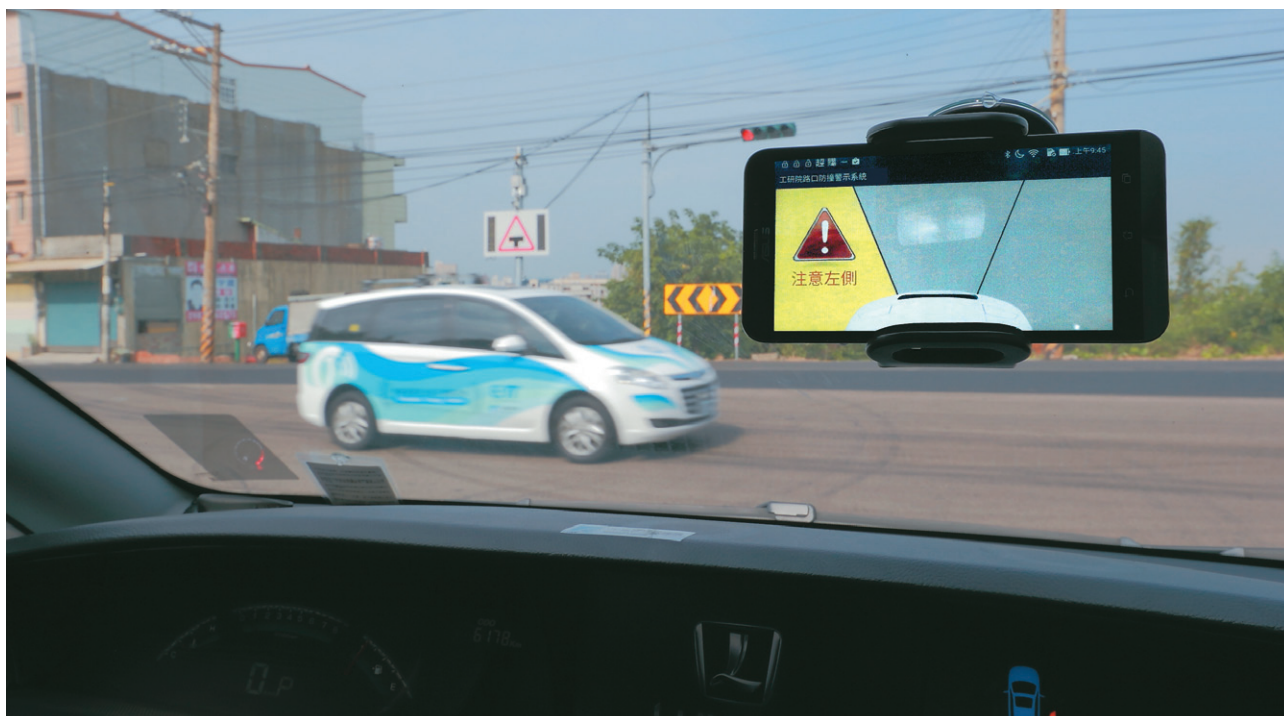
系統配備看板功能，讓尚未搭載 V2V 設備的車輛也能利用路口的電子看板注意路口是否有來車接近。
