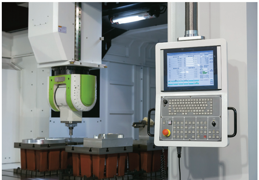
航太級五軸龍門加工機採用工研院研發的五軸精微加工中心控制器，具備了五軸刀具姿態控制功能，可以側面刀刃完成銑削，讓航太結構件能達到最高效率、最高精度的加工結果。
