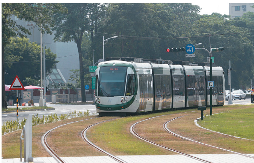
超級電容器非常適合用於每站間隔不長的大眾運輸交通工具，例如高雄捷運環狀輕軌列車是分散式的電聯車，採用超級電容器電池供給動力的方式推進。
