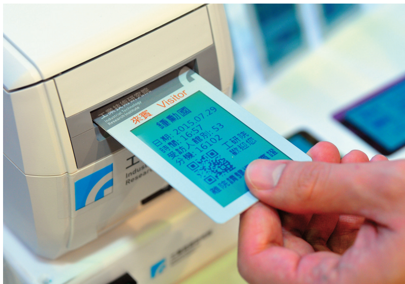
TAD 可重覆使用熱寫電子紙技術，具有環保節能及可多次重覆使用的優點，適合應用於票卡市場。
