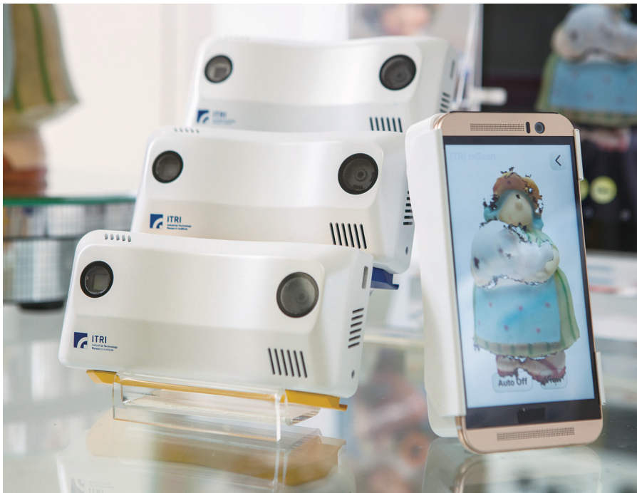
「無線行動 3D 掃描器」獲得金牌獎，是全球首款專為 Android 智慧行動裝置設計的彩色 3D 掃描器，掃描精度品質佳、體積小、重量輕。
