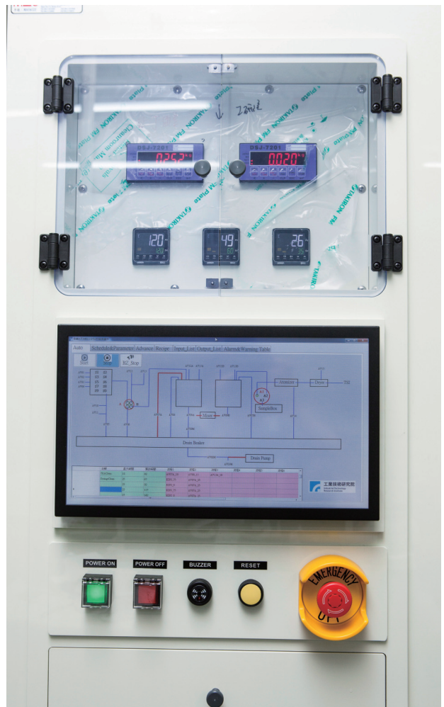
透過新世代溶液中奈米微粒監控系統，一發現溶液粒子不符需求，就馬上暫停及更換，以維持產品良率。
