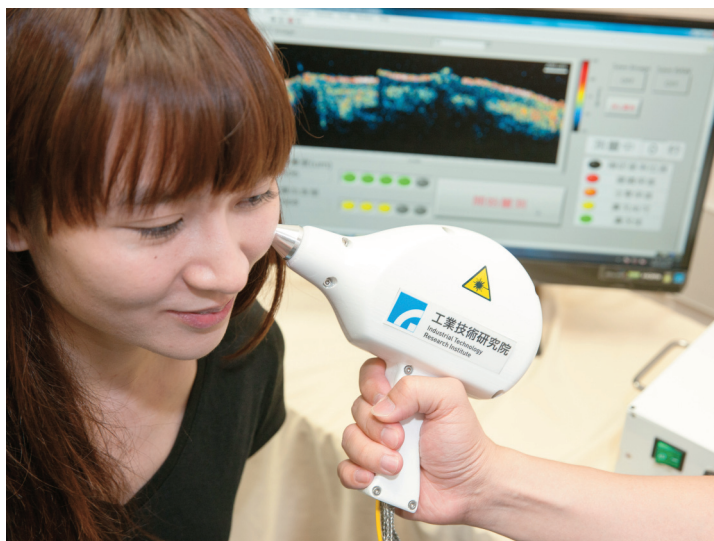
手持式光學同調斷層掃描機可清楚呈現表皮及真皮層厚度分布、膠原蛋白含量分布及毛孔狀況等膚質的型態變化。
