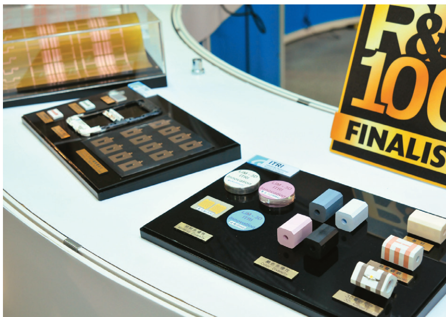
「雷射誘發積層式 3D 線路技術」入圍 2015 全球百大科技研發獎，技術核心在利用獨創的雷射誘發金屬化技術，使得基材的選擇不再侷限於塑料，且能採用積層式製造技術。
