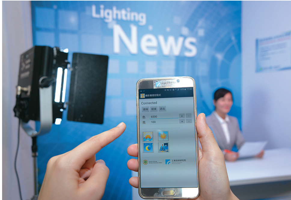
工研院與國內業者合作開發的 LED 智慧攝影棚持續燈，還能運用智慧型手機的 App 自由調整色溫與光輸出、快速調整多組燈具達成最佳的色彩表現。
