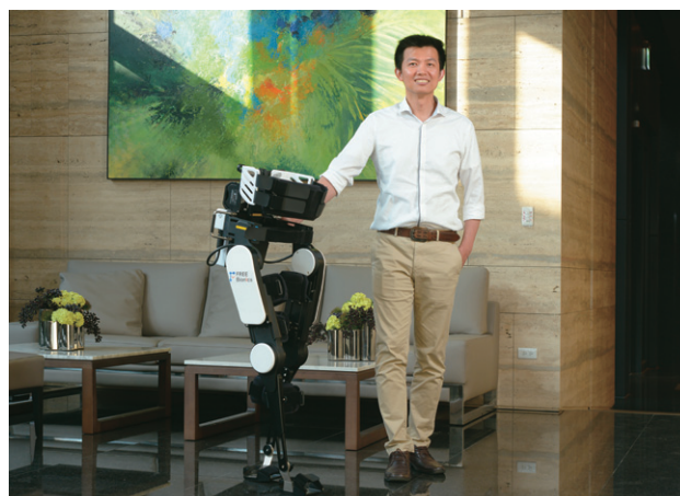
行動輔助機器人以穿戴式外骨骼機器人的設計，透過動力輔助來協助傷友重獲站立、坐下、平路行走、上下樓梯與斜坡的能力。
