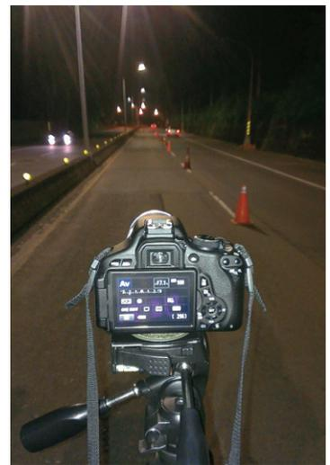
「快速道路 LED 智慧化路燈系統」可與相機整合，透過相機測量路燈的平均輝度跟均勻性。
