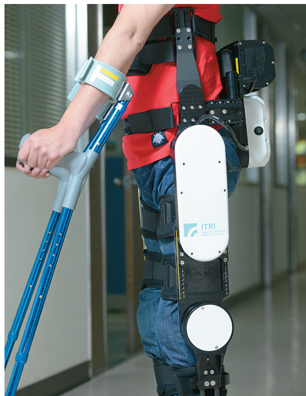
行動輔助機器人能透過動力輔助來協助傷友行動，而第二代的成品更在輕量化和安全性的層面上有顯著的進步。
