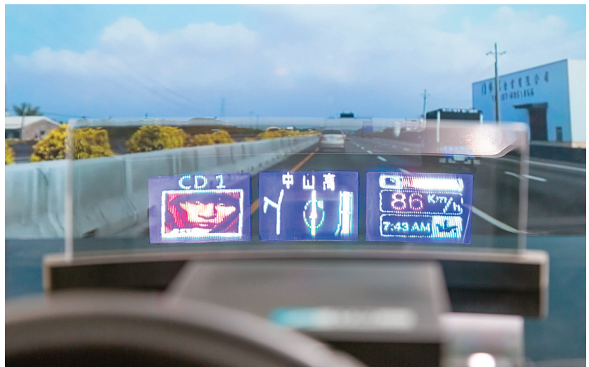
遠距浮空多屏抬頭顯示器可投射出寬幅虛像畫面於汽車擋風玻璃前，提供駕駛更多的行車資訊。
