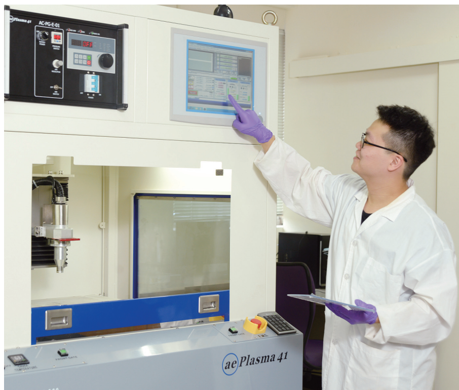
透過大氣壓電漿鍍膜技術，不需仰賴真空環境，且能避免在製程中使用有毒材料，既環保又降低製程成本。
