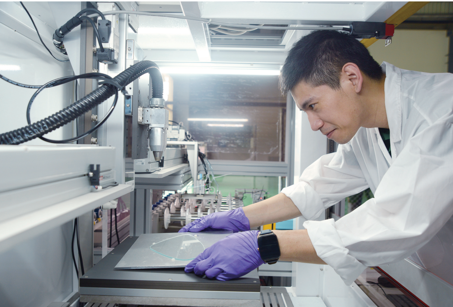
雷立強光電利用創新的電漿設備，能鍍出品質極佳的透明導電薄膜。
