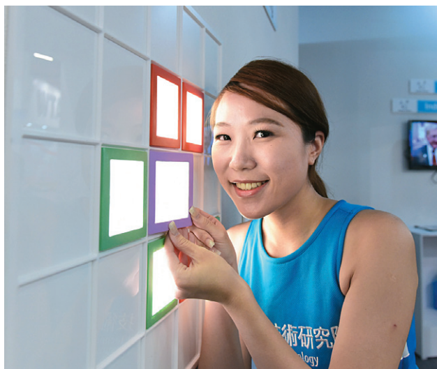
工研院展示如磁磚般輕薄 OLED 照明光源模組，能隨意貼在無線充電背板上發光。
