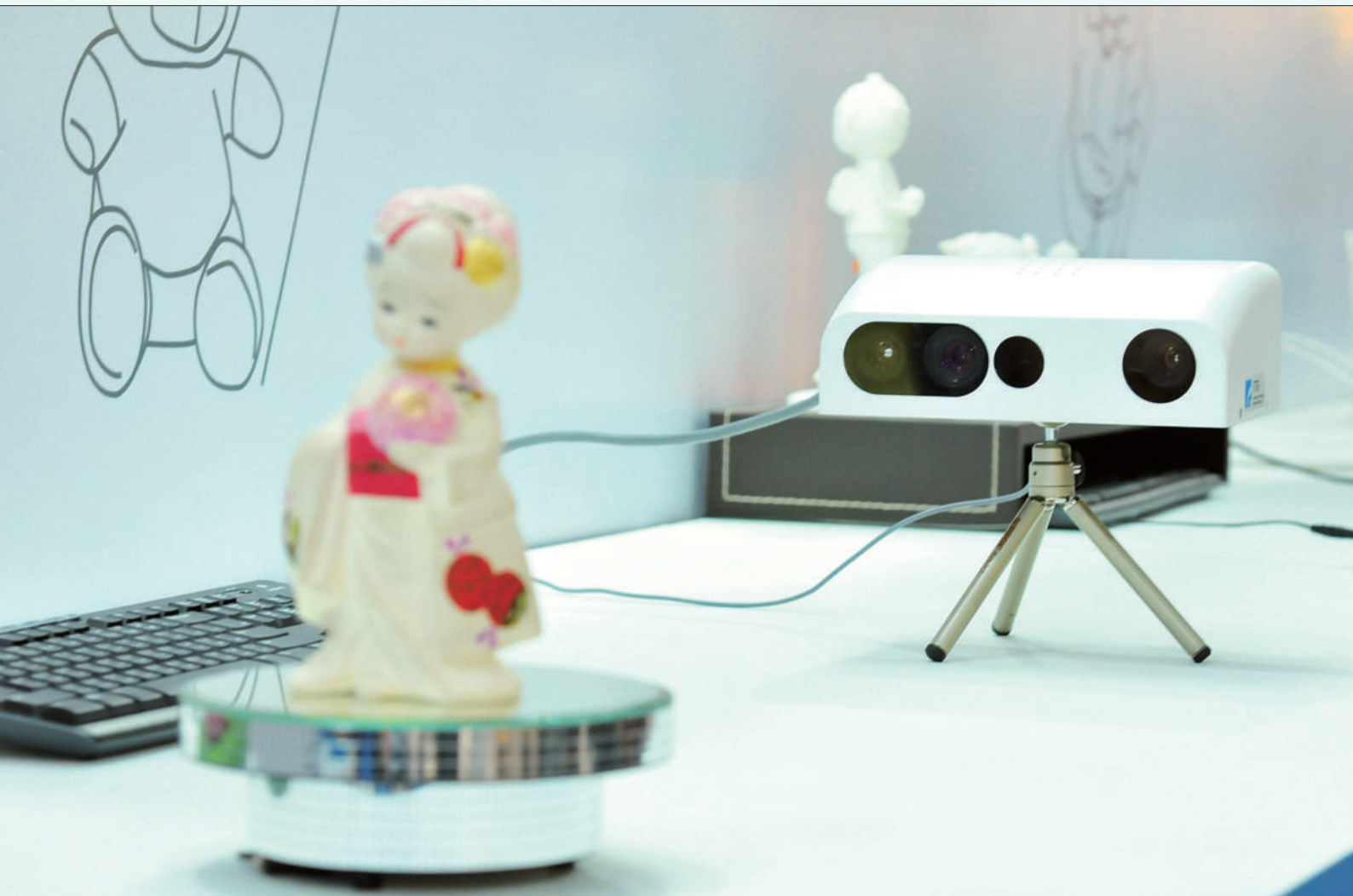
桌上型 3D 掃描器是以紅外線投射到被測物體，再利用雙攝影機裝置同步擷取物件的影像，並且即時堆疊成形，快速完成掃描。
