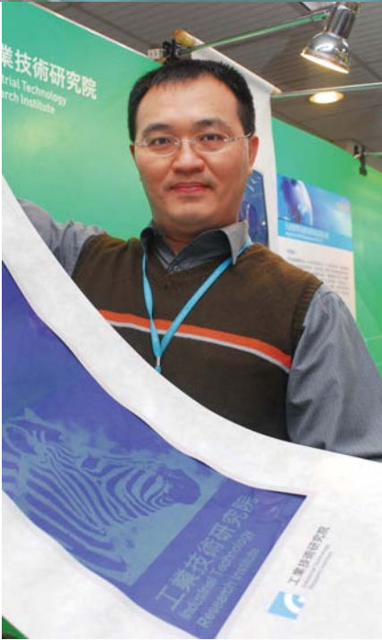
採用卷對卷方式生產的軟性顯示器，可以像畫軸一樣收捲，而且可以視廠商或消費者的需要，任意製造出要多長都可以的相關產品。
