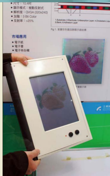
工研院研發的單層彩色膽固醇液晶顯示器，可讓RGB三原色同時在一層面板上出現，可應用於彩色電子書、數位相框等電子紙產品。
