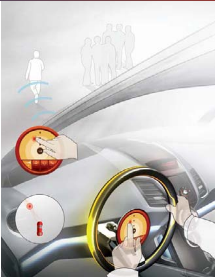
「數位式方向盤」整合喇叭、背投影與觸控面板等技術，想要「叭」哪個方向就往哪個方向，不會影響到其他不相干的人。
