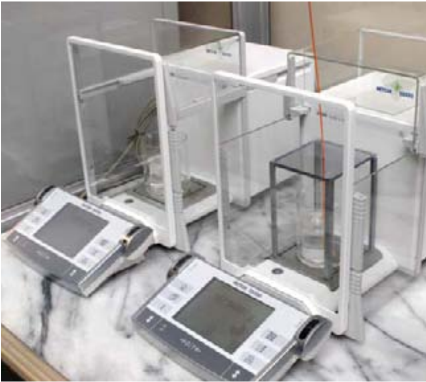
工研院量測中心的微流量量測系統採用動態稱重法，是目前國際間最小流量的國家級校正系統。
