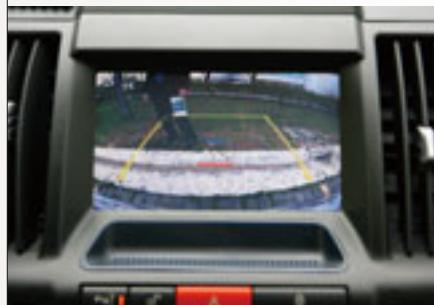
結合影像與雷達，讓影像式倒車輔助導引系統成為全天候適用的輔助系統。
