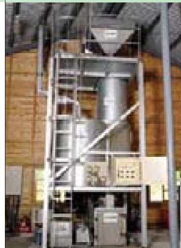
直立式生質能碳化爐利用熱氣往上升的物理現象來設計，有效節省碳化製程中所需的熱能，並大幅縮短碳化時間。
