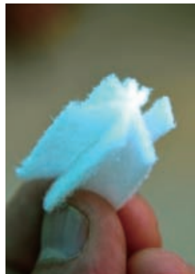
海綿寶寶BioNET多孔性擔體，可以攔截水中懸浮固體物，去除氮磷等有機物。
